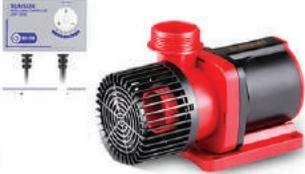
A JDP-6000 apresenta até 65% de economia de energia em relação às bombas comuns, possui trava de segurança no rotor com sistema de segurança contra funcionamento a seco, em caso de falta de água, controle externo de ajuste da vazão e função pausar o funcionamento por alguns minutos, para limpeza ou alimentação dos peixes.
